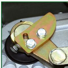
Stop mécanique réglable dans les deux directions
