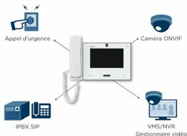
Totalement compatible avec le protocole ONVIF Profil S, l'IX peut être intégré avec un système tiers également compatible ONVIF Profil S.
